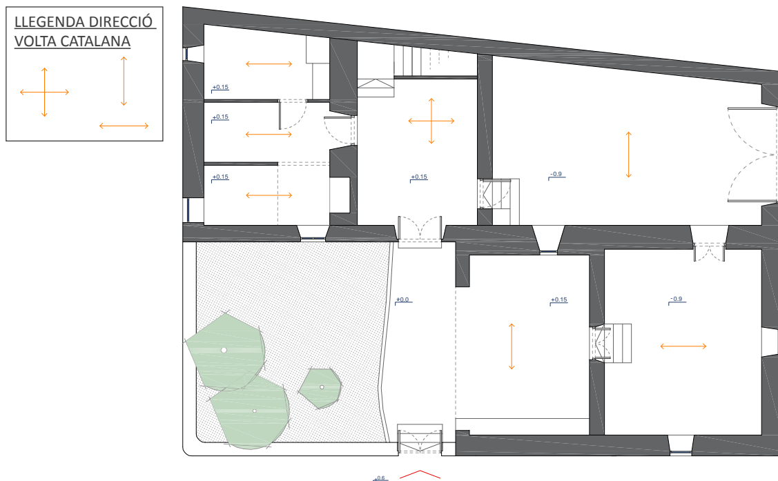
Fig.10. Plànol estat actual de la planta baixa.
