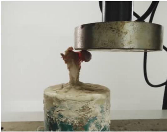
图2 犬股骨颈骨折内固定标本力学测试情景
