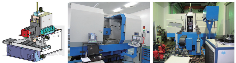
图1 大口径卧轴矩台精密磨床2MK7160及其辅助配套系统 Fig.1 2MK7160 precision grinding machine
