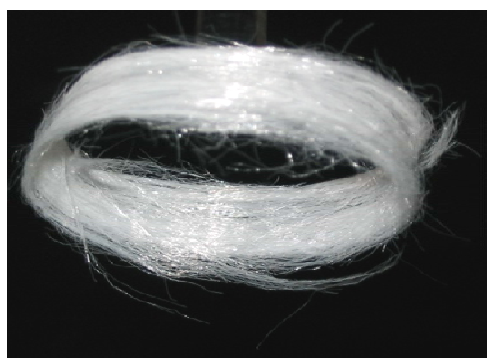
图 34 高强度 ZrO 2 连续纤维照片 Figure 34 Photograph of high strength ZrO 2 continuous fibers
