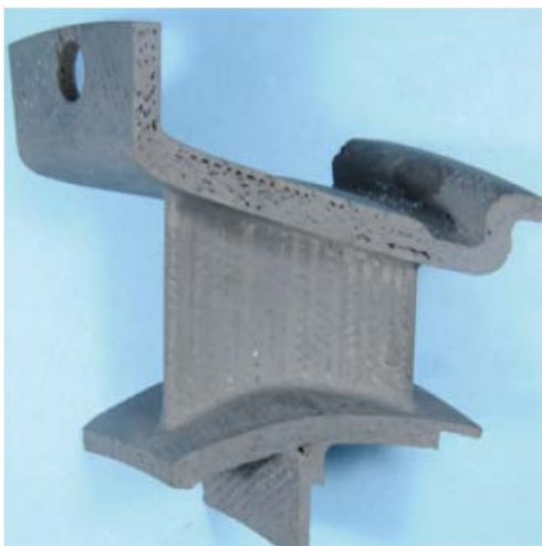
图 4 日本 IHI 公司制备的 SiC f /SiC 复合材料静子叶片 [23] Figure 4 Appearance of SiC f /SiC vane manufactured by IHI Co., Japan [23]
