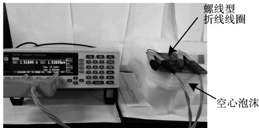
图9 线圈的阻抗测量实验
