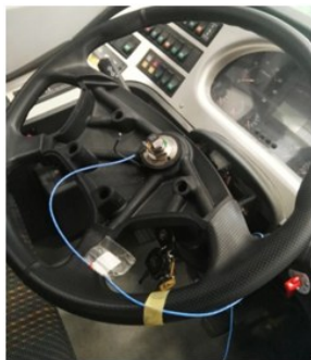
图3 方向盘抖动摸底试验
