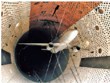
(b) 亚跨超风洞条带支撑
