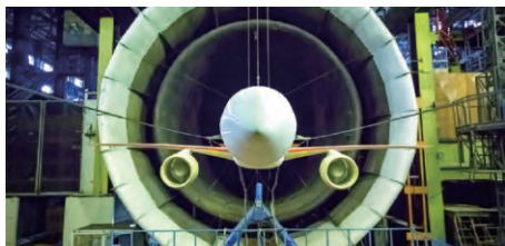
(c) 亚声速全模颤振绳系支撑
