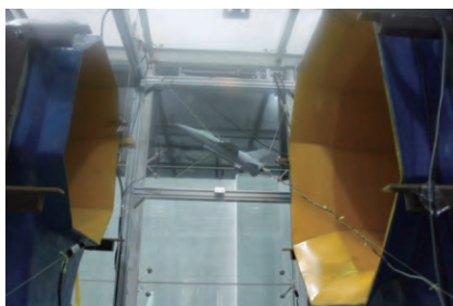
(c) 第3代样机低速风洞试验
