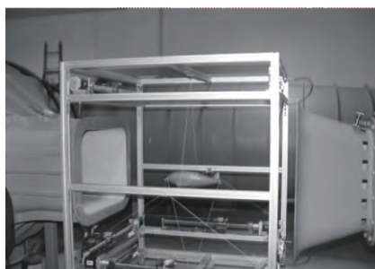
(a) 第1代样机低速风洞试验
