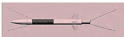
图 18 张线支撑弹箭模型示意图 [48]
