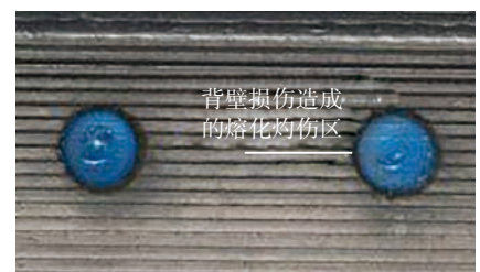
(b) 背壁损伤造成的熔化灼伤区
