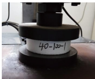
图3 泡沫材料压缩试验
