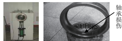
图 4 加载装置及故障轴承图片
