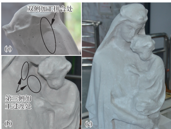
(a) 双侧加工拼合处局部图;(b) 第三侧精加工过渡处局部图;(c) 雕塑全局图.
