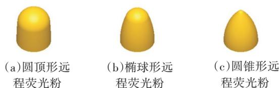
图 1 三种荧光粉样品示意图
