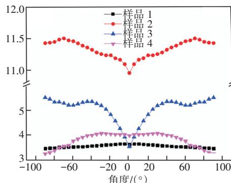
(b)平面硅胶封装的蓝光LED激发下的YBR空间分布
