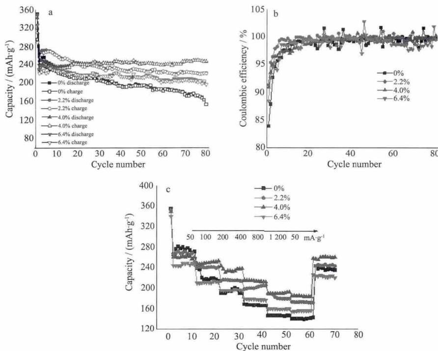
图 4 TiO<sub>2</sub> 和 Ag@TiO<sub>2</sub> 电极(a)放电容量循环图, 电流密度为 200 mA·g<sup>-1</sup>, (b)库伦效率图, (c)倍率性能图, 电流密度 50、100、200、400、800 和 1 200 mA·g<sup>-1</sup>
