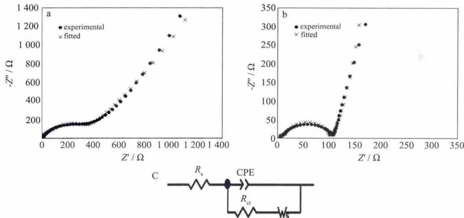
图 7 (a) TiO<sub>2</sub> 和(b) Ag4.0@TiO<sub>2</sub> 电极交流阻抗测试图谱和(c)等效电路图,测试电位为开路电压约 3.0 V(vs Li/Li<sup>+</sup>)
