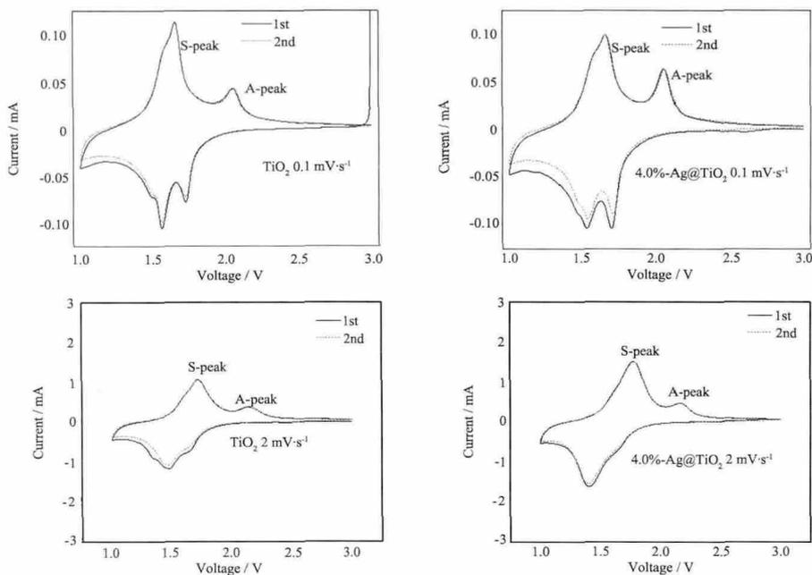
图 6 (a)TiO<sub>2</sub> 在 0.1 mV·s<sup>-1</sup> 下的循环伏安图,(b)Ag<sub>4.0</sub>@TiO<sub>2</sub> 在 0.1 mV·s<sup>-1</sup> 下的循环伏安图,(c)TiO<sub>2</sub> 在 2 mV·s<sup>-1</sup> 下的循环伏安图,(d)Ag<sub>4.0</sub>@TiO<sub>2</sub> 在 2 mV·s<sup>-1</sup> 下的循环伏安图
