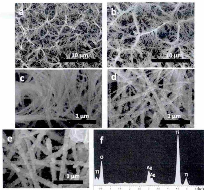
图 2  $\text{TiO}_2$ (a)和  $\text{Ag}_{4.0}@\text{TiO}_2$  (b)的放大 SEM 图及对应的 EDX 图谱(f),  $\text{Ag}_{2.2}@\text{TiO}_2$  (c)、 $\text{Ag}_{4.0}@\text{TiO}_2$ (d) 和  $\text{Ag}_{6.4}@\text{TiO}_2$ (e)的 SEM 图
