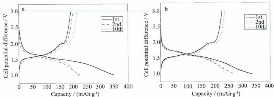
图 5 (a)TiO<sub>2</sub> 和(b) Ag<sub>4.0</sub>@TiO<sub>2</sub> 电极的充放电曲线图
