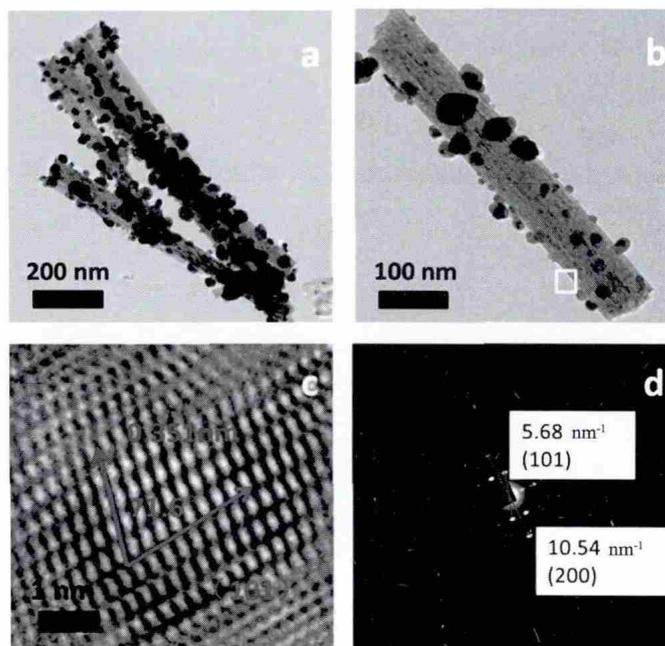
图 3  $\text{Ag}_{4.0}@\text{TiO}_2$  的 TEM 图(a, b)、HRTEM 图(c)和(b)图对应的 SAED 图(d)
