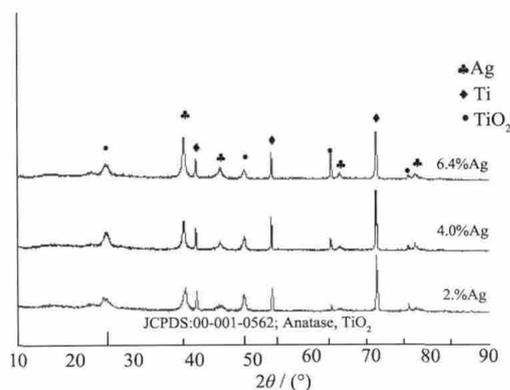
图 1 不同 Ag 含量的 Ag@TiO<sub>2</sub> 纳米材料 XRD 图
