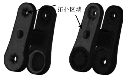
图 10 大臂简化后的模型
