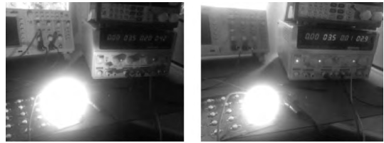
(a) V_{cc} 高于欠压阈值,主灯亮,辅灯灭 (b) V_{cc} 低于欠压阈值,主灯灭,辅灯亮
