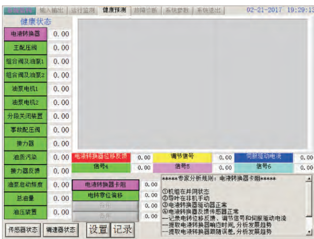
图 5 水轮机调速系统健康状态预测界面
