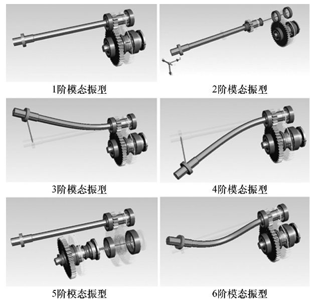
图 10 动力输出总成前 6 阶模态振型示意图 Fig.10 First Six-order Vibration Modes of Assembly
