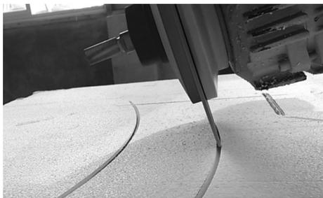
图5 圆孔加工示意图
