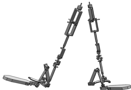
图4 左腿SOLIDWORKS模型实际情况
