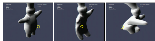
图 3 在 Sony PS2 上模拟弹性物体在外力作用下的形变(图中的圆圈是光标, 表示外力的作用点 [18] )
