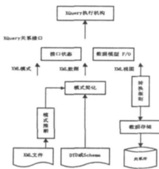
图 1 基于模式方法支持 XQuery 的系统结构图
