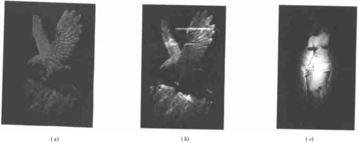
图 4 采用了两种方法后,以参考光 80^\circ 记录的全息图像,有效抑制了有害干涉条纹
