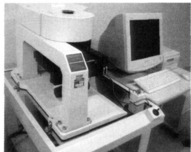
图 2 OLS1200-FAR2 型激光共聚焦扫描显微镜
