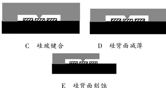
图2 微机械隧道陀螺仪工艺流程
