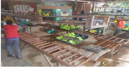
Figura 57. Bandas transportadoras de la fruta elaborada en madera.
