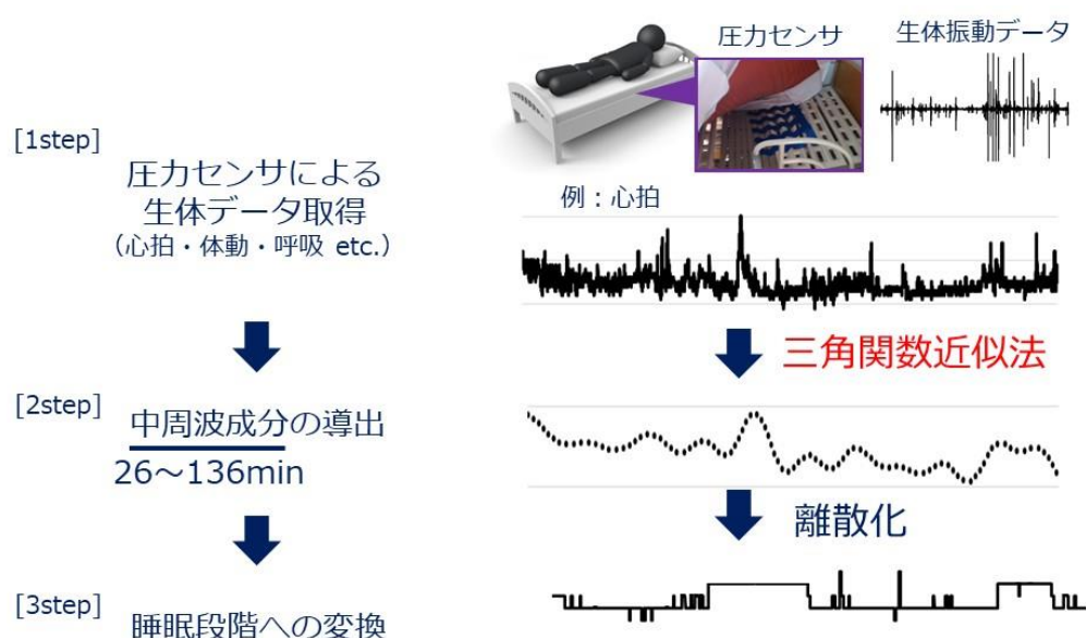
図 3-2 三角関数近似を用いた無拘束型睡眠段階推定法の推定フロー
