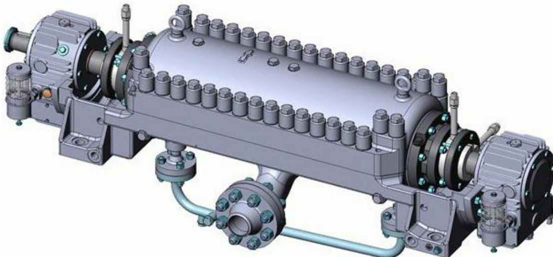
Рисунок 1.2 - Общий вид насоса НПС 120/65-750
