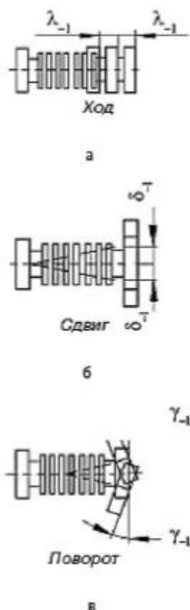
Рисунок 2.8 –Схема работы компенсатора: осевого– а, сдвигового – б, поворотного – в.
