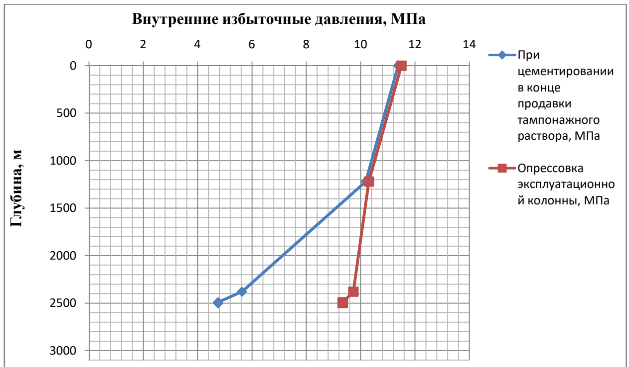
Рисунок 5 – Эпюра внутренних избыточных давлений
