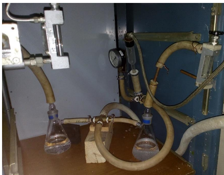
Рисунок 2.2 – экспериментальная установка для исследования формирования кристаллов из водного раствора NaCl в магнитном поле.
