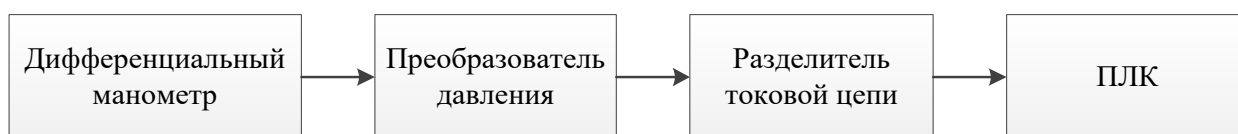
Рисунок 2.3 – Структурная схема канала измерения расхода ДГ
