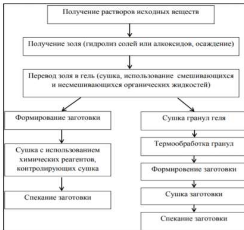
Рисунок 1.4 – Этапы получения нанопорошков золь-гель методом
