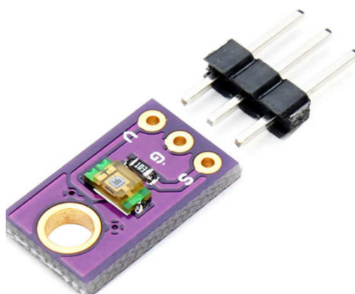
Рис. 27 Интегральный датчик освещённости temp6000
