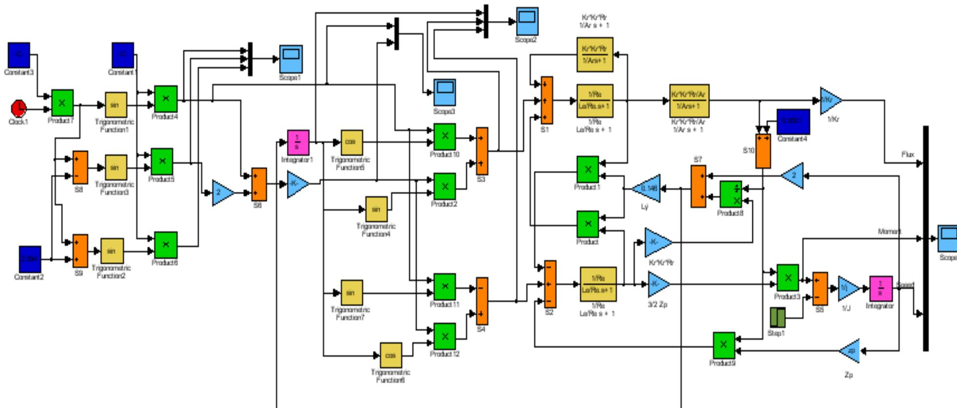
Рисунок 17 - Структурная схема имитационной модели АД во вращающейся системе координат
