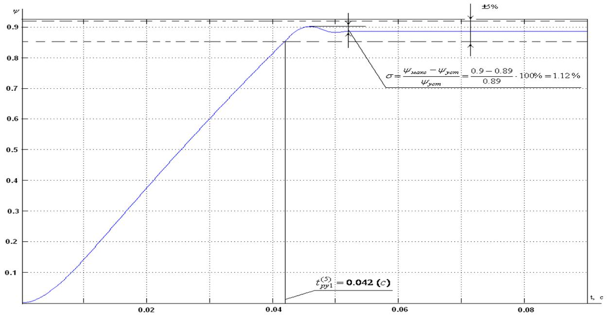
Рисунок 37 - Динамическая характеристика модуля вектора
