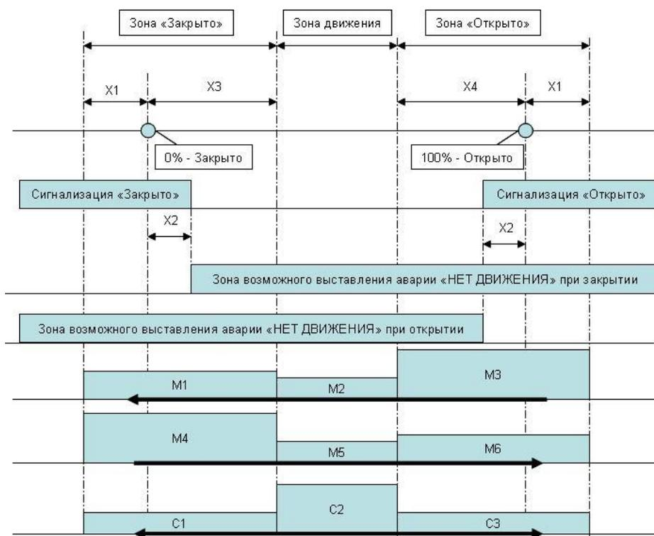
Рисунок 7 – диаграмма работы блока в составе электропривода
