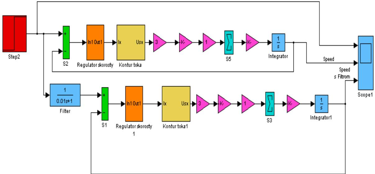
Рисунок 24 – Имитационная модель контура скорости настроенного на СО
