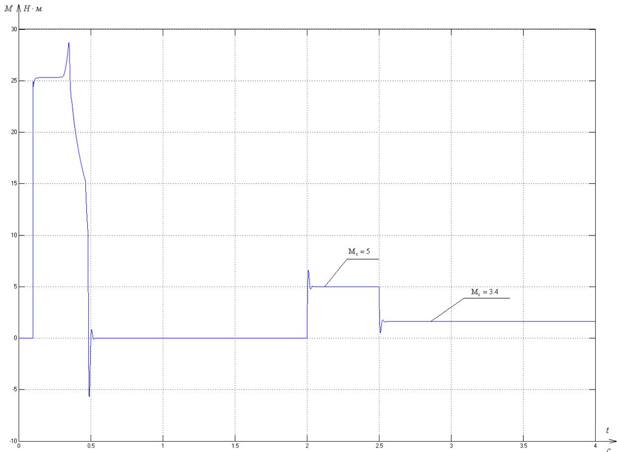
Рисунок 40 – переходные процессы при пуске на холостом ходу и последующим набросе нагрузки 5 Нм, затем уменьшаем нагрузку до 3,4 Нм (при скорости 157 рад/с)
