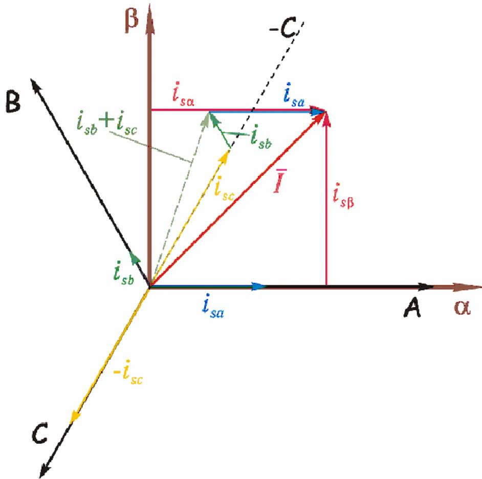
Рисунок 14 - Схема преобразований вектора напряжений  $U_s$
