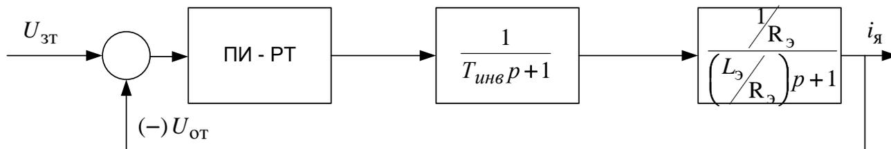
Рисунок 20– Структурная схема контура тока настроенного по МО
