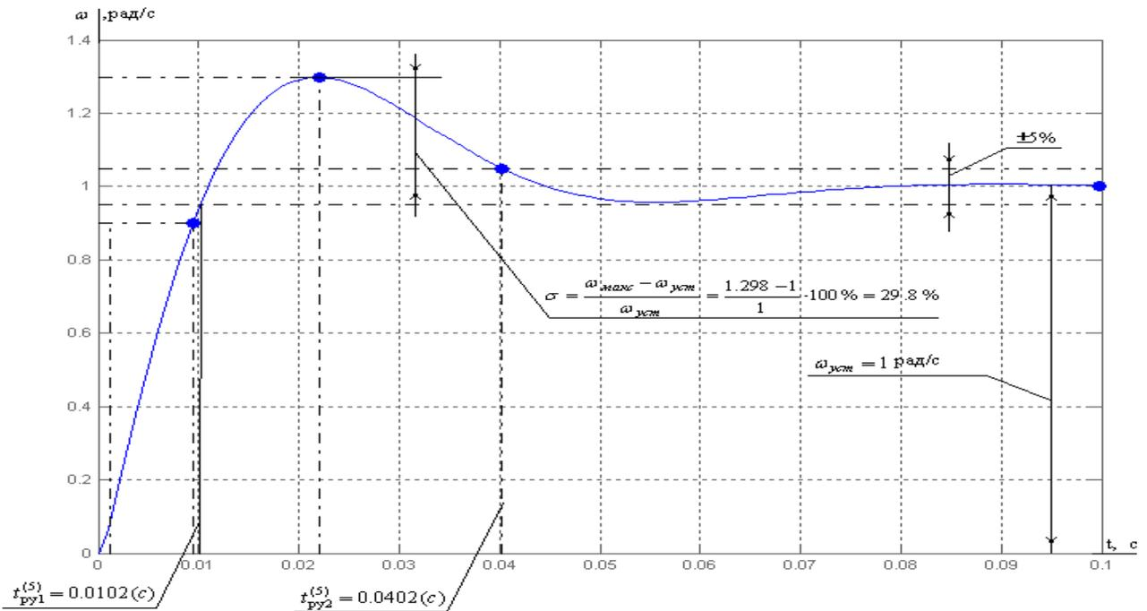
Рисунок 25 – Переходные характеристики  $\omega(t)$  контура скорости настроенного на СО без фильтра на входе
