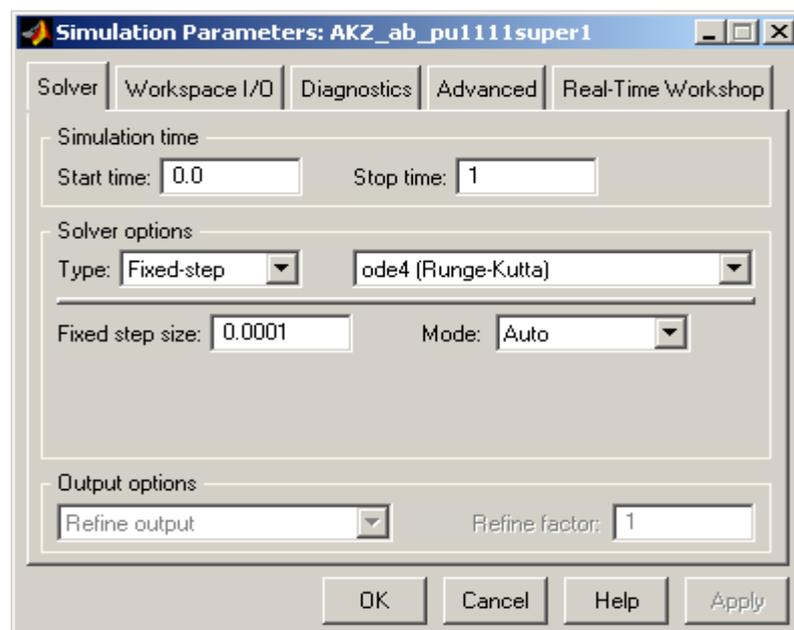
Рисунок 13 - Внешний вид настройки параметров расчета асинхронной машины
