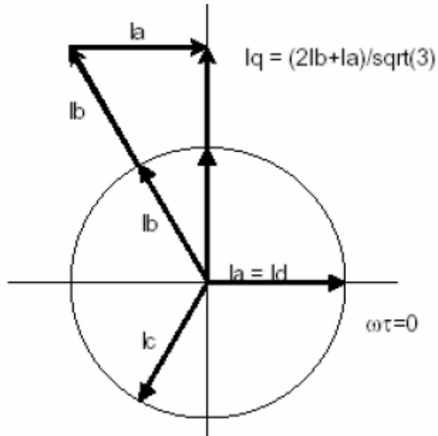
Рисунок 9. Преобразование Кларка (Clarke Transformation)
