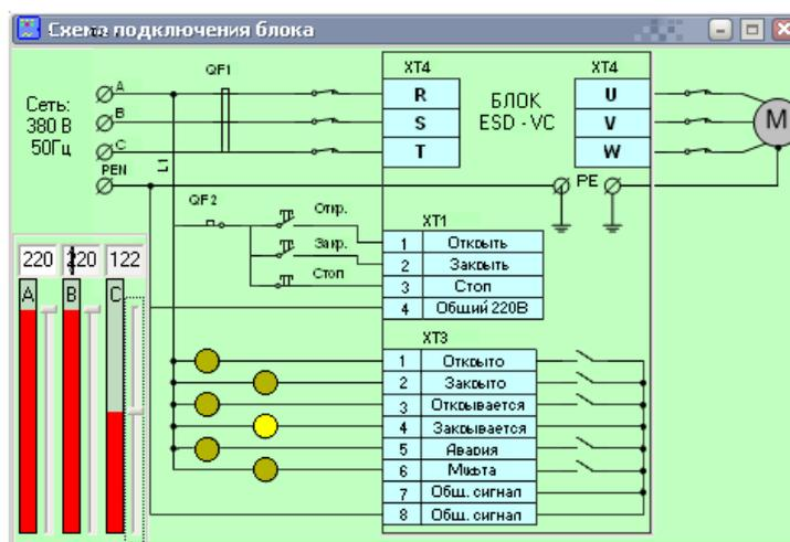
Рисунок 46 – интерфейс схемы при снижении напряжения на фазе С до 122 В
