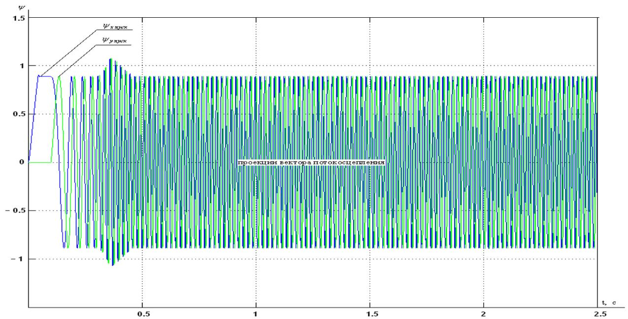
Рисунок 34 - Динамические характеристики потока двигателя (при скорости 157 рад/с)
