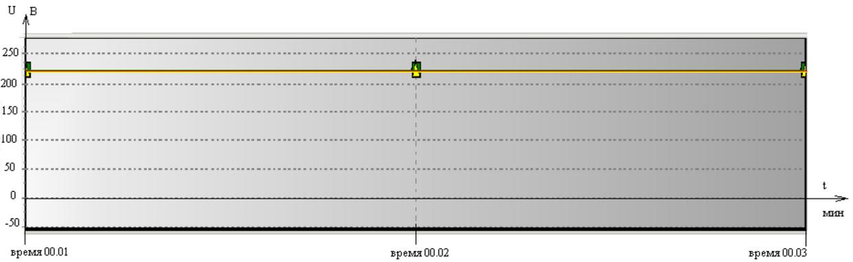
Рисунок 43 – Напряжение фаз на блоке при команде ЗАКРЫТИЕ
