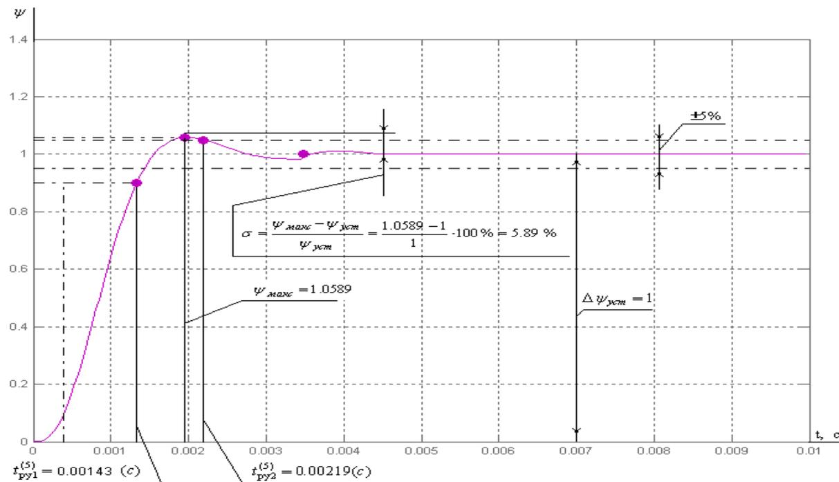
Рисунок 29 – Переходные характеристики контура потокосцепления
