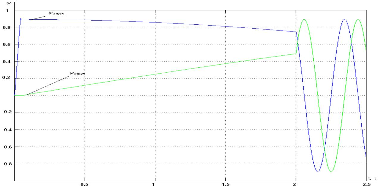
Рисунок 35 - Динамические характеристики потока двигателя (при скорости 0,157 рад/с)
