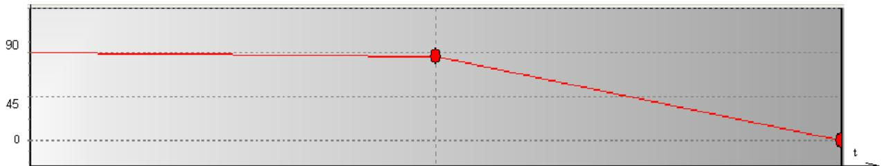
Рисунок 45 – положение задвижки при закрытии
