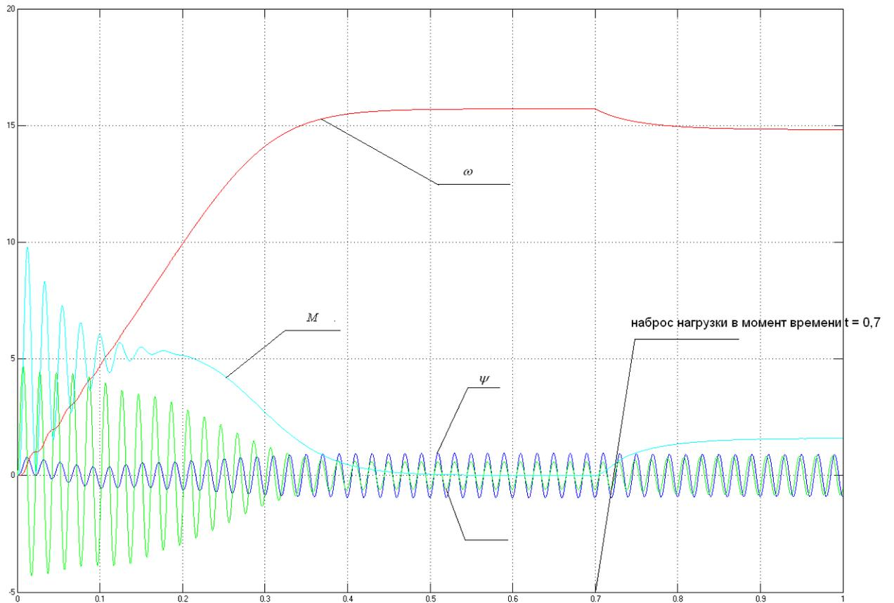
Рисунок 12 - Переходные процессы при пуске и набросе нагрузки асинхронной машины в неподвижной системе координат
