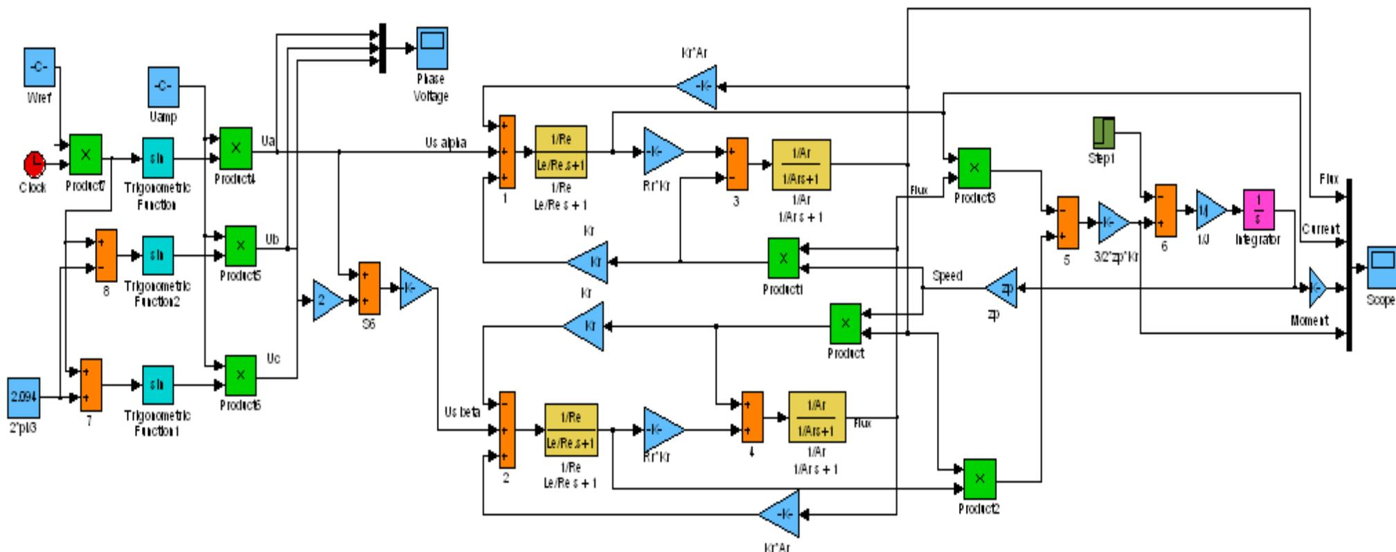
Рисунок 11 - Структурная схема имитационной модели АД в неподвижной системе координат
