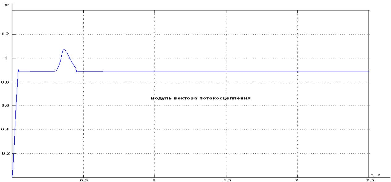
Рисунок 36 - Динамическая характеристика модуля вектора потокосцепления (при скорости 157 рад/с)
