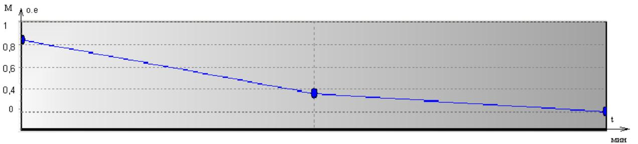
Рисунок 44 – Момент на валу двигателя при закрытии
