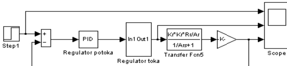
Рисунок 28 – Имитационная модель контура потокосцепления, настроенного на МО
