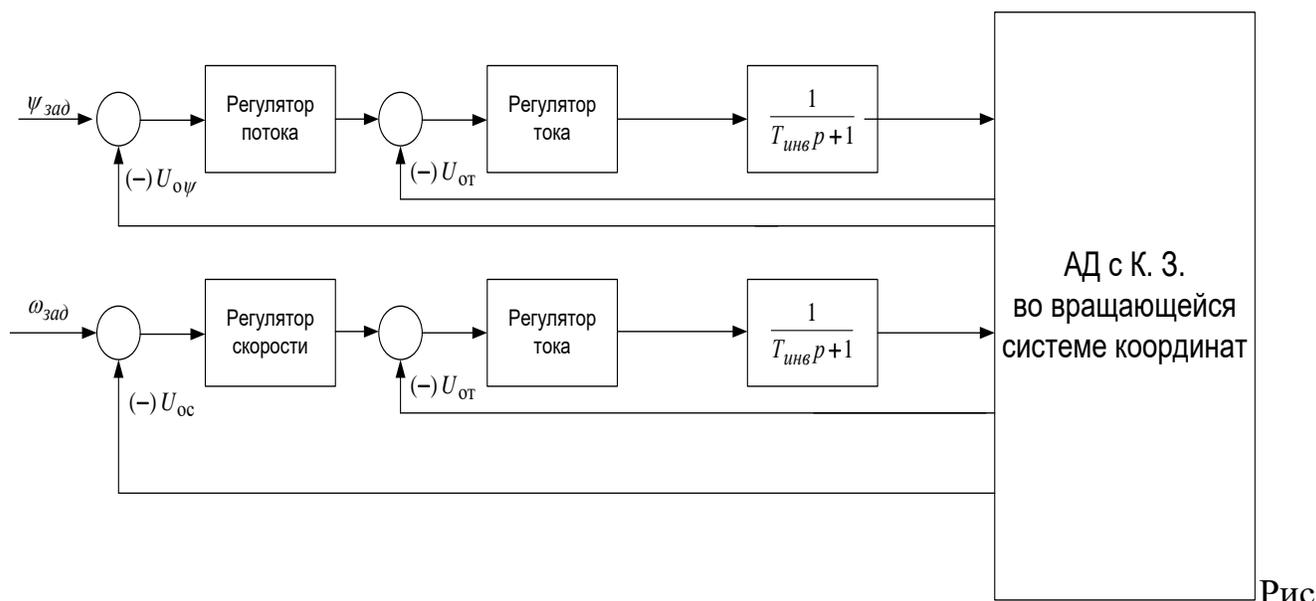
унок 19 – Структурная схема САУ СЭП
