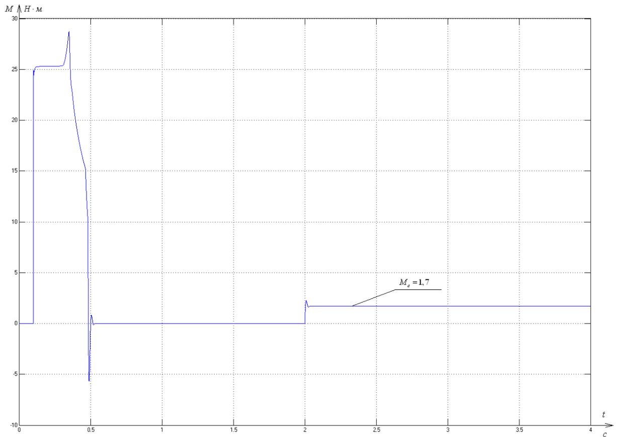
Рисунок 38 - Переходный процесс момента при пуске на холостом ходу и последующем набросе нагрузки (при скорости 157 рад/с)
