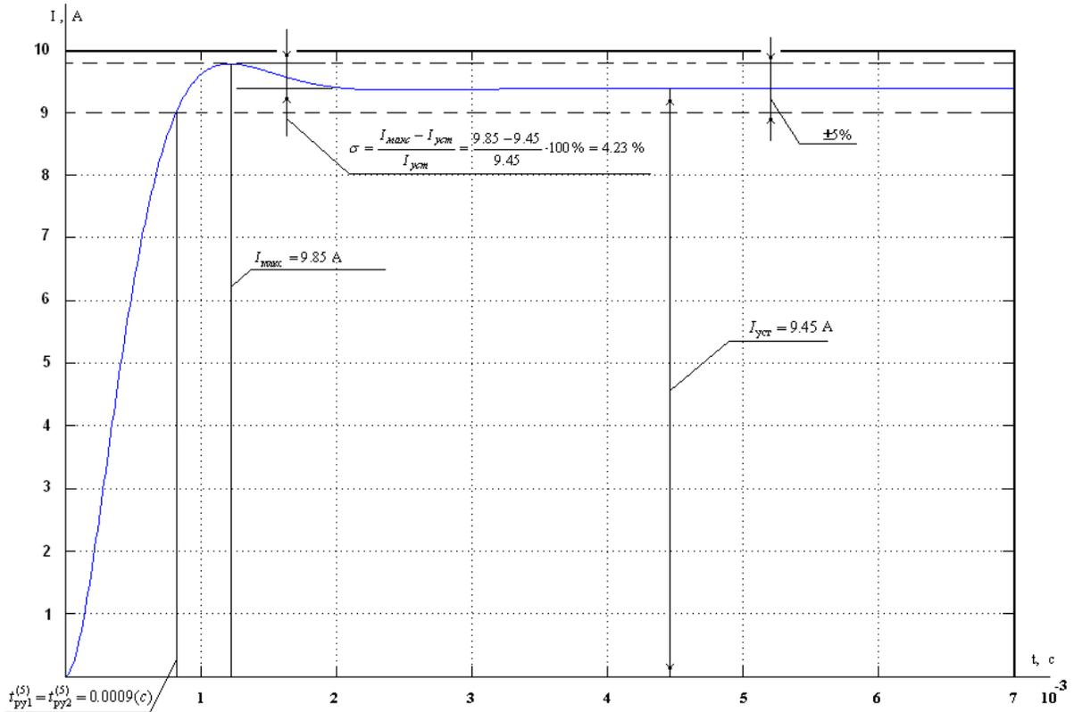
Рисунок 22 - Переходная характеристика  $i(t)$  контура тока
