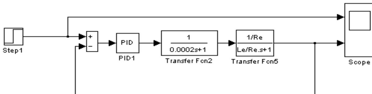
Рисунок 21 - Имитационная модель контура тока, настроенного по МО
