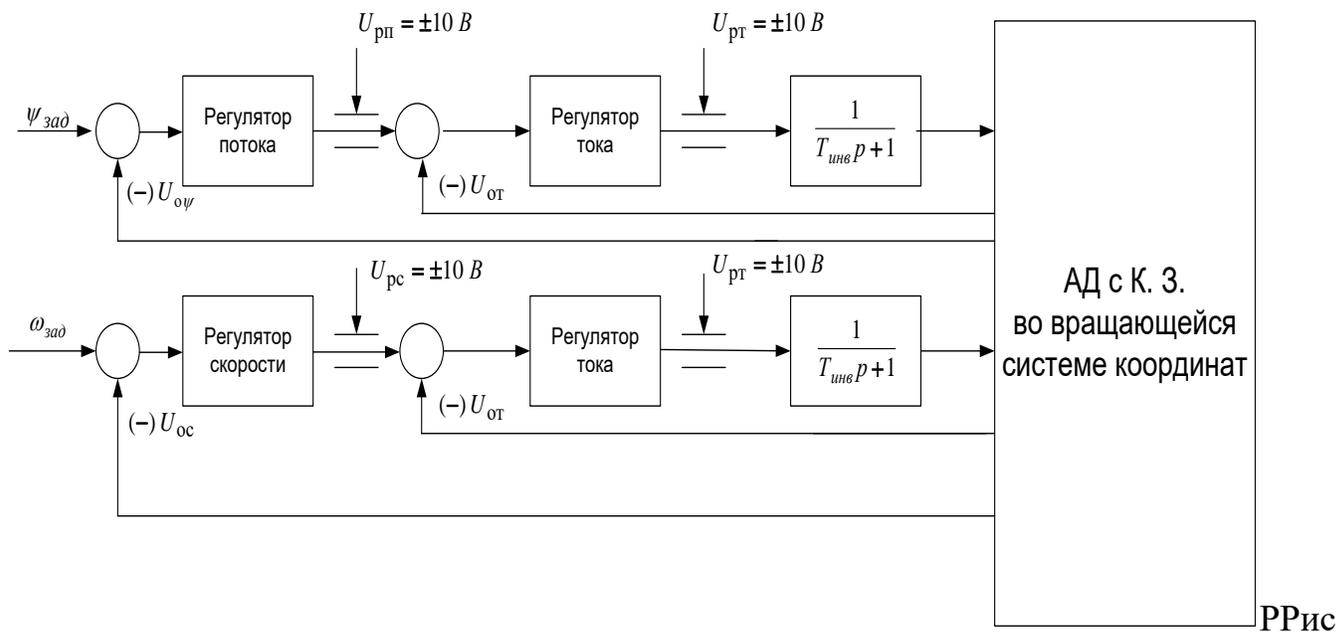
унок 31 - Структурная схема нелинейной САУ СЭП
