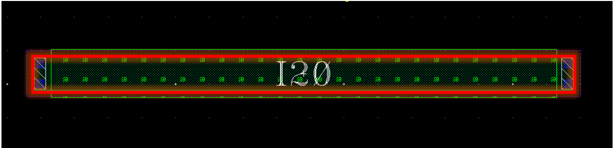
Рисунок 4.5 – Топологія резистора rrp1 з виділеною областю можливих дефектів
