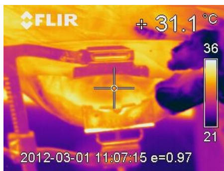
Рис. 7. Фрагмент теплового портрета в конце процесса ВЧ сварки тканей миокарда человека
