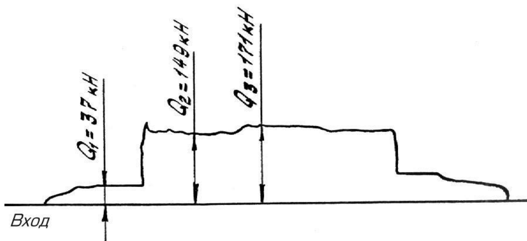
Рис. 7.25. Осцилограма сили протягування гільзи ДВС автомобіля ЗИЛ 130 деформуючим інструментом (змащення 5% розчин емульсії)
