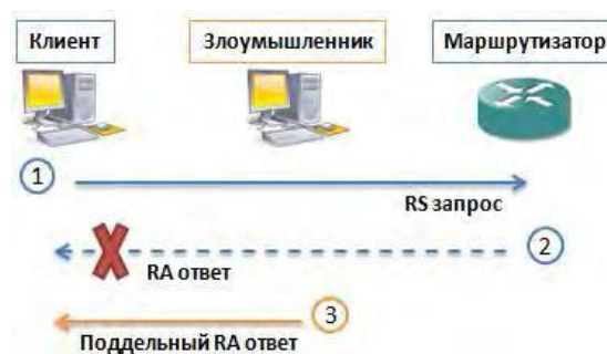
Рисунок 2.1. Механізм атаки на процес виявлення маршрутизатора в IPv6
