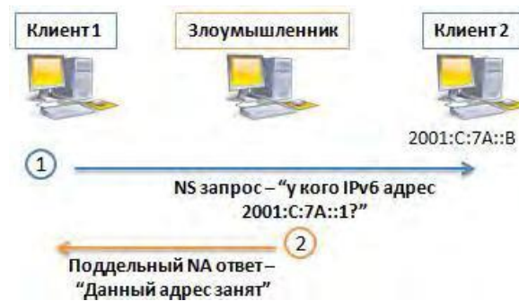
Рисунок 2.3. Механізм атаки на процес виявлення дублюючої IPv6 адреси
