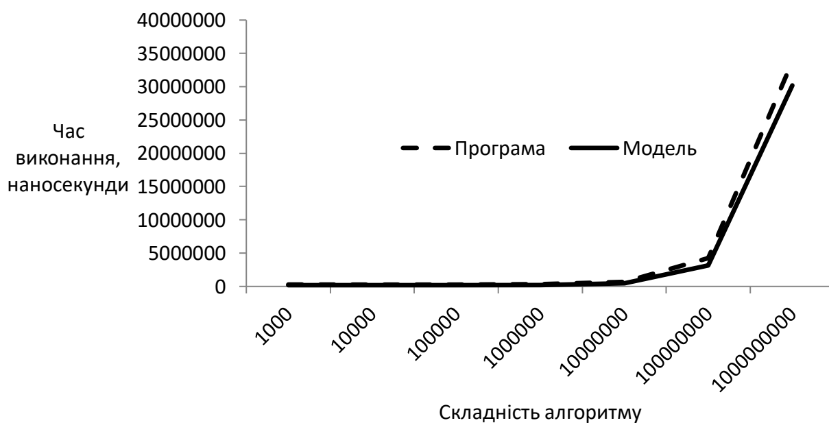
Рисунок 3.5 – Порівняння часу виконання багатопоточної програми та її моделі, за умови наявності 2 завдань та 2 потоків у пулі
