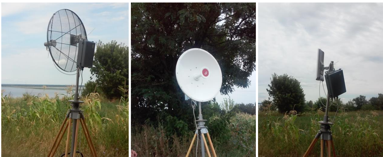
Рис. 1. Вузьконаправлені, та секторна антена 120град. на шпильі
