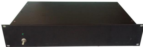
Рис. 3. Блок живлення з акумуляторною батареєю для автономного живлення радіорелейної станції
