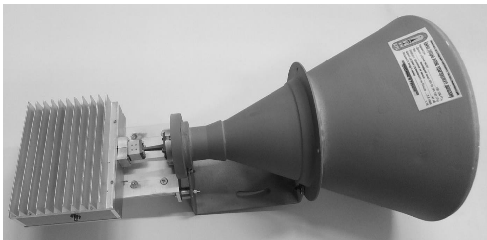
Рис. 5. Приймопередавач групового сигналу в діапазоні 130 ГГц з направленою антеною для радіорелейної лінії зв'язку
