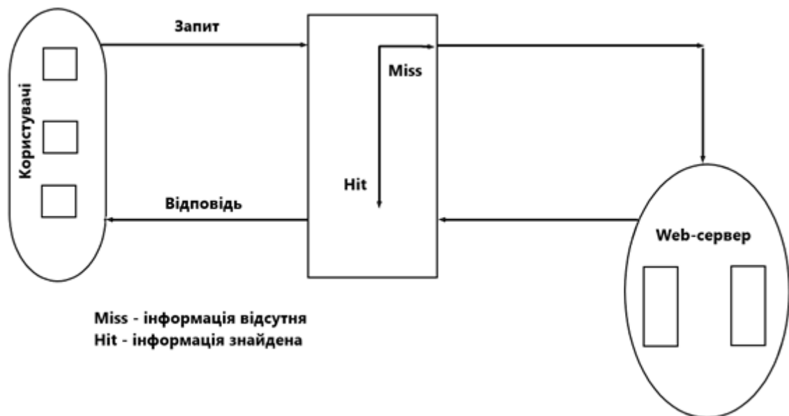
Рисунок 3.8 Архітектура проксі-сервера для Web
