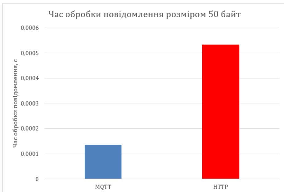
Рисунок 3.15 Час обробки повідомлення розміром 50 байт
