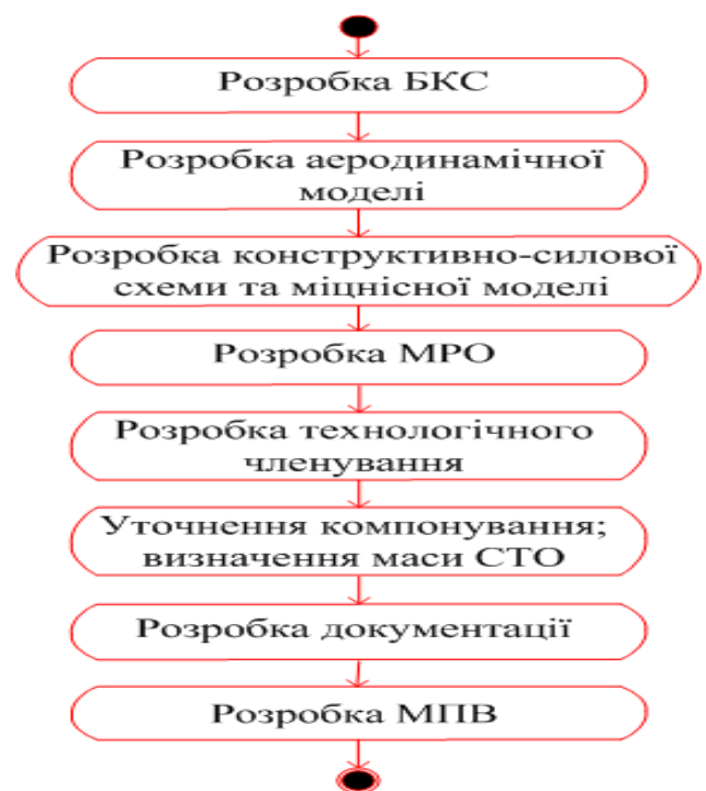
Рисунок 1.5 – Метод інтегрованого проектування та комп'ютерного моделювання
