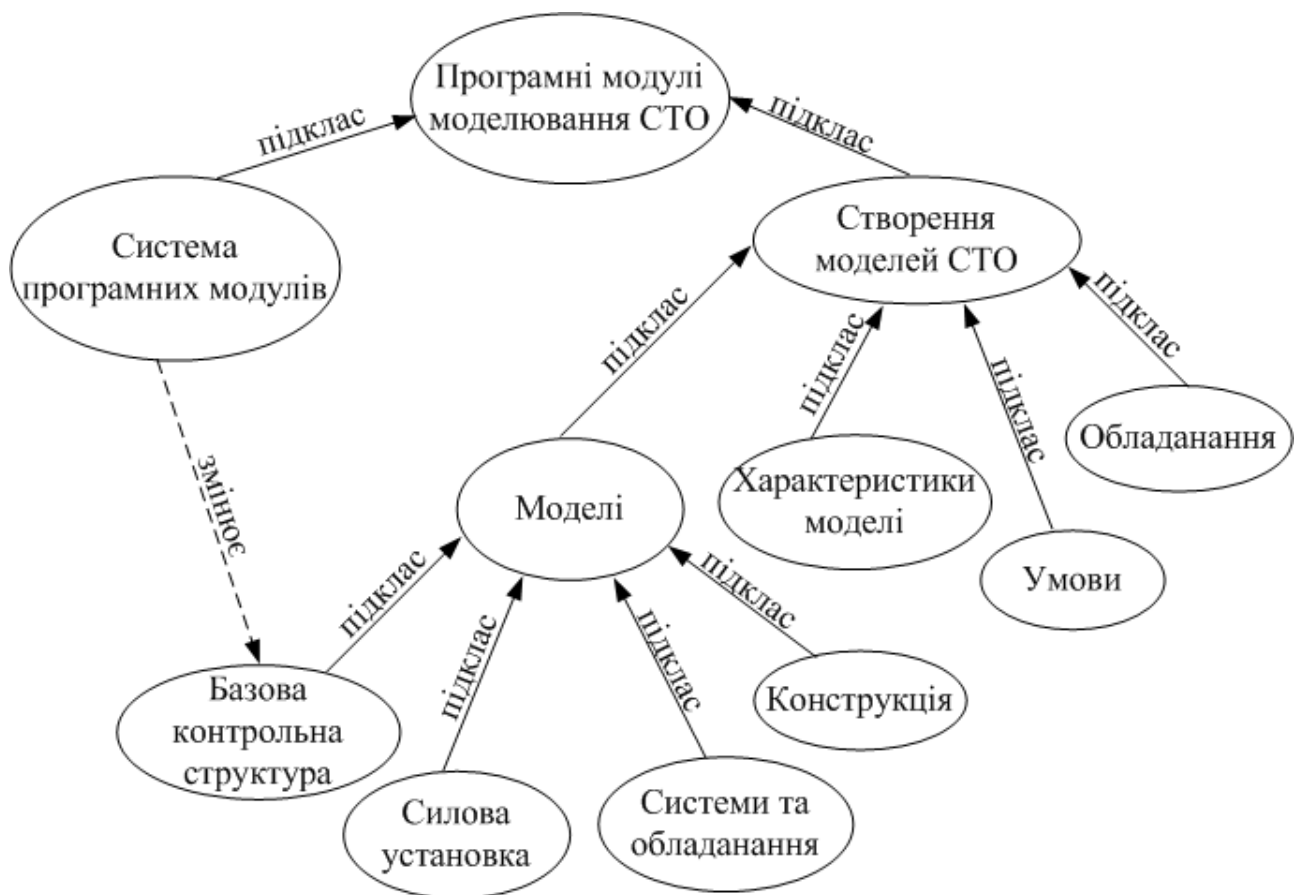
Рисунок 3.9 – Структурна схема використання програмних модулів для побудови моделей складного технічного об'єкта
