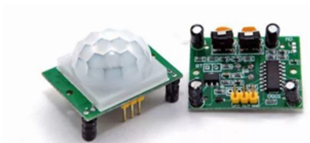
Рис 3.9. HC-SR501 піроелектричний інфрачервоний датчик руху PIR
