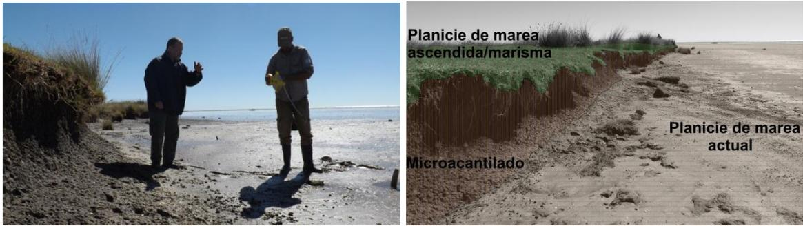
Figura 2.5: Medición de la distancia entre el punto fijo y la base del micro-acantilado, en la planicie de marea.
