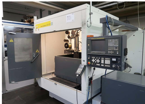
Abbildung 57 – FANUC Robocut \alpha -1c Drahterodiermaschine
