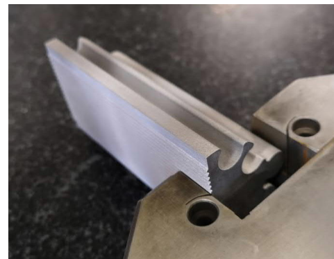
Abbildung 79 – Vorbereitung für den zweiten Schnitt im Schraubstock
