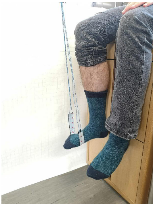
Abbildung 20 – Versuchsaufbau Messung von Fusshebekraft; Gesamtansicht
