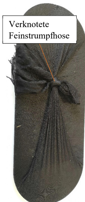
Abbildung 67 – Obere Gussform mit der verknoteten Feinstrumpfhose
