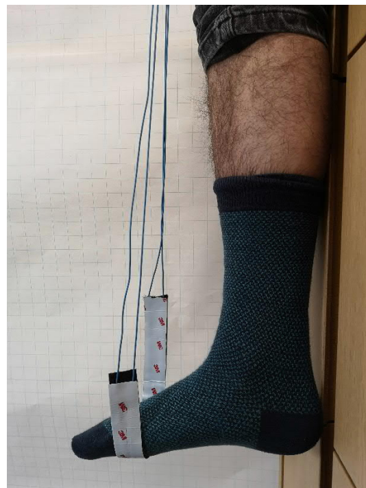
Abbildung 21 – Versuchsaufbau Fusshebekraft Messung; Seite
