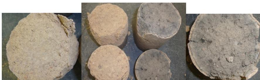
Figura 12: Aspeto visual das composições sem e com resíduo, após ensaio a 400 e 600°C
