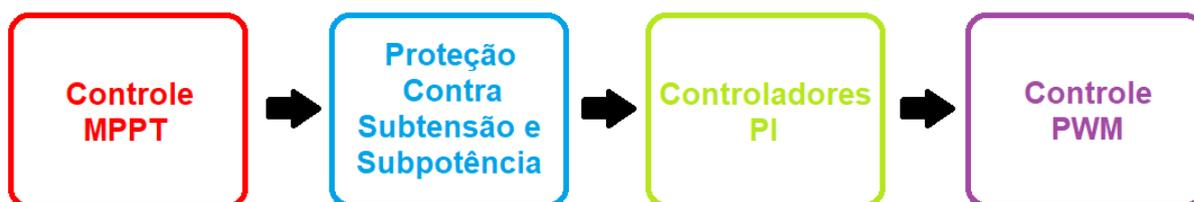
Figura 2.13 – Principais malhas de controle do conversor *boost* do estudo.
