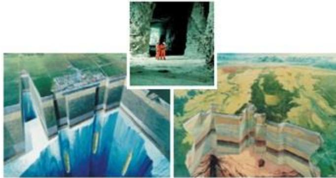
Fig. 3.6 Sistemas de almacenamiento subterráneo en formaciones de sal (izquierda), minas abandonadas (centro) y rocas porosas (derecha) (20).
