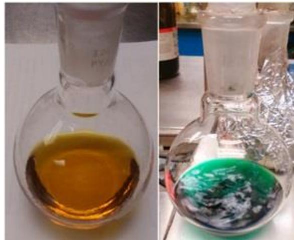
Fig. 6.4 MOFs en síntesis MIL-53 (Fe), MIL-53 (80%Ni20%Fe).
