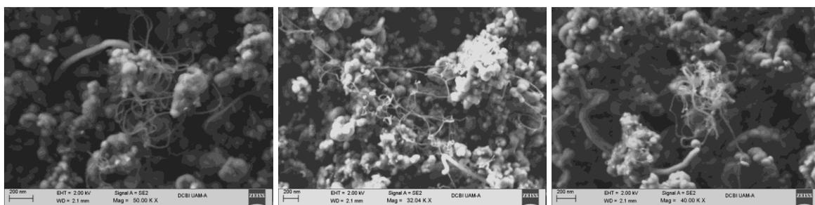
Fig. 7.39 Micrografías de NTC NC Fe-BTC sin purificar.
