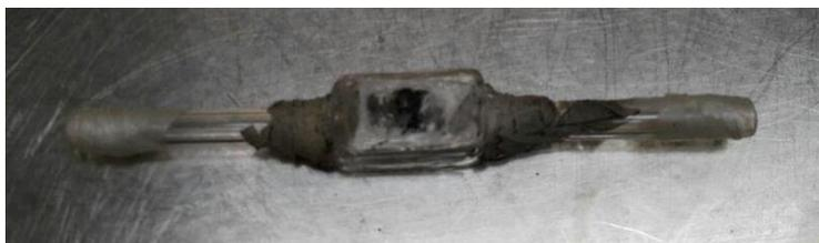
Fig. 8.6 reactor de cuarzo para caracterización Raman *In situ*.
