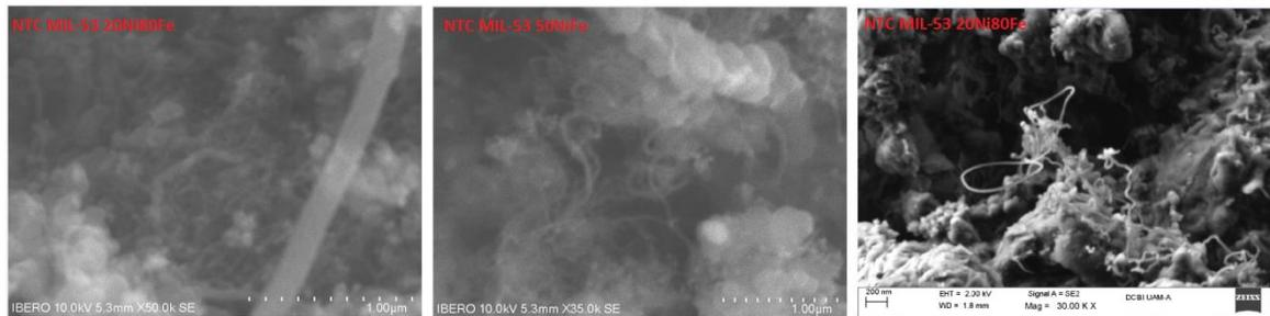
Fig. 7.16 Micrografías (MEB) de NTCs de MOFsMIL-53 de Ni-Fe.
