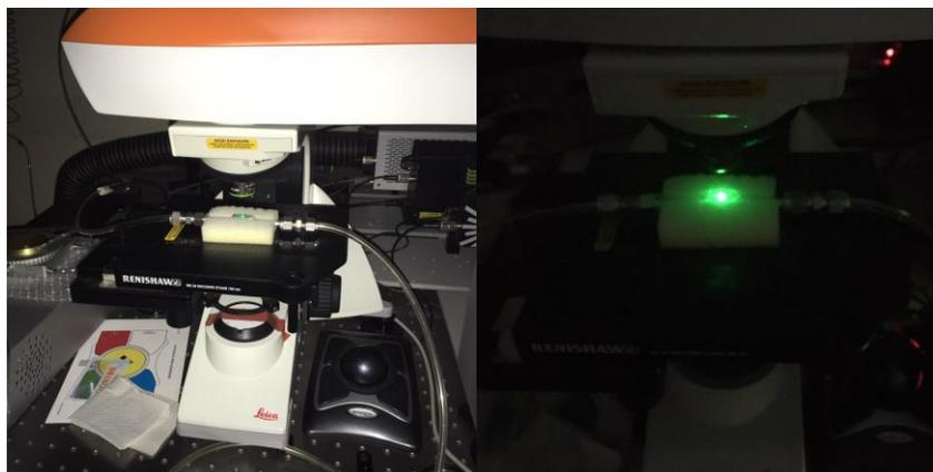
Fig. 7.46 Sistema de adsorción de H<sub>2</sub> seguido por espectroscopia Raman. (Láser verde 532 nm).
