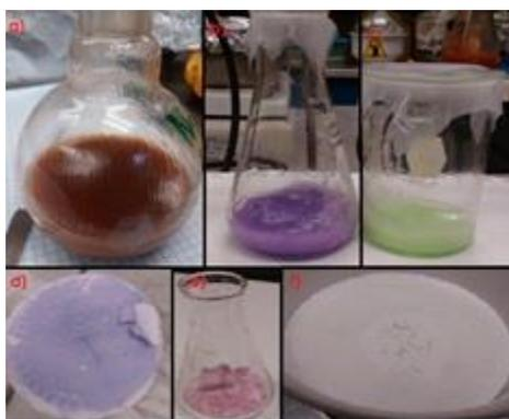
Fig. 6.2 MOFs en síntesis, a) Fe-BTC, b) Co-BTC y c) Ni-BTC, d) Co-BTC filtrada, e) Co-BTC seca y f) Ni-BTC filtrada.
