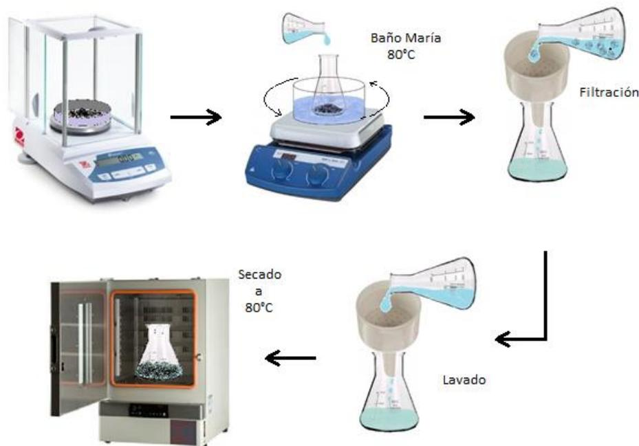
Fig. 6.7 Esquema de purificación de NTC.
