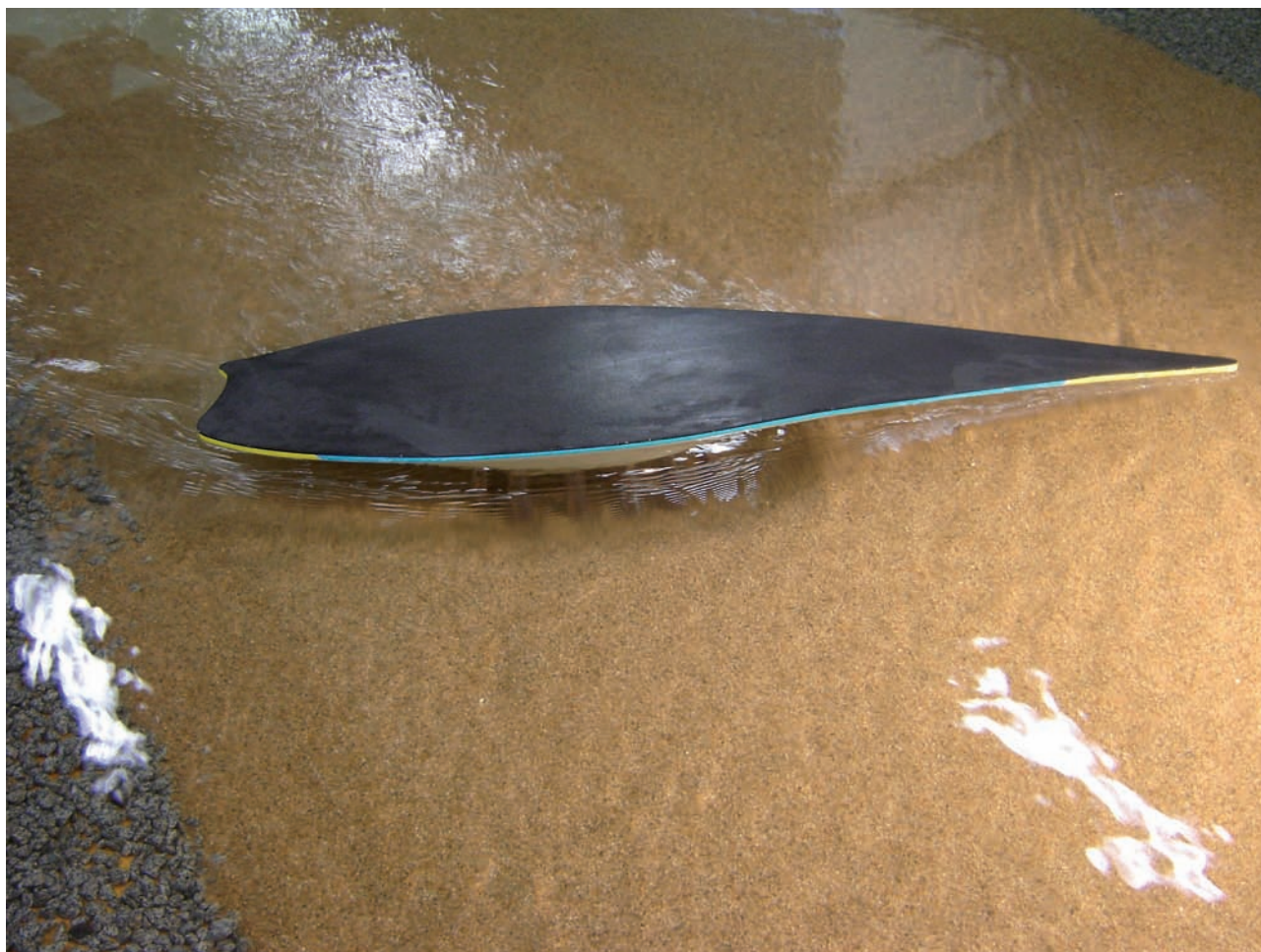
Fig.6. Ensayo de erosión local. Foto tomada en las primeras horas de ensayo.
