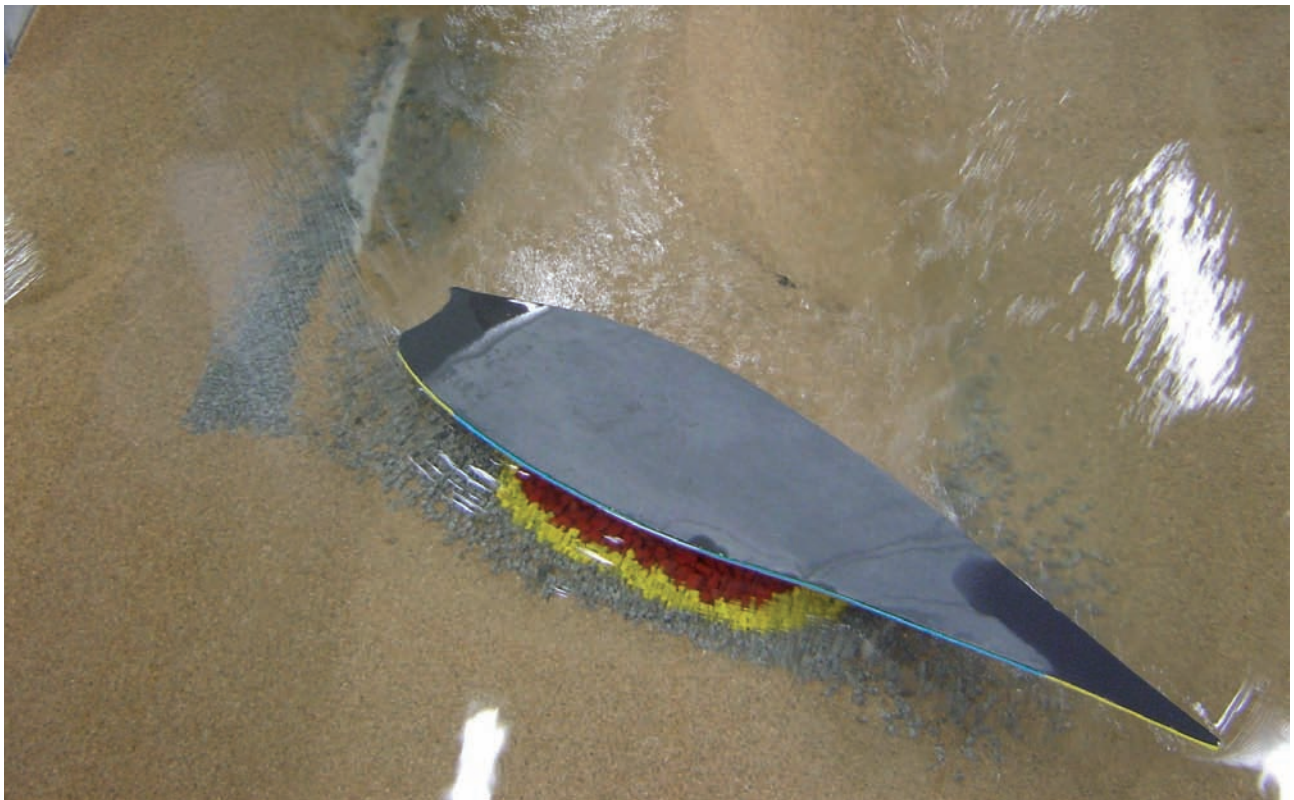
Fig.10. Protección recomendada tras horas de ensayo. Roja: 3000 kg; amarilla: 50% de anchura en 600 kg. Se ve el filtro en el pie de la margen, sin que caiga la protección. Se distingue muy bien, tras la pila, la meseta.
