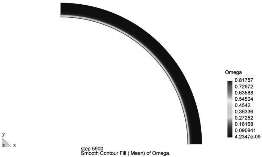
Figura 9-51. Mapa de colores del daño térmico a 98.3 minutos.
