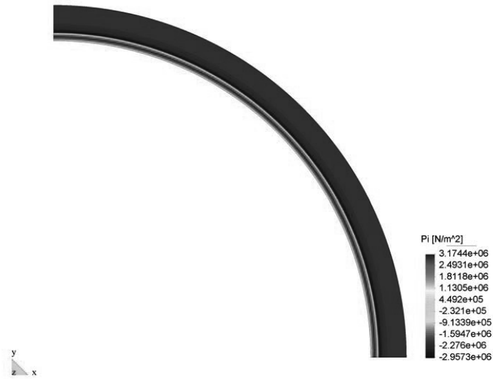
Figura 9-47. Mapa de colores de presión equivalente de poros a 98.3 minutos.
