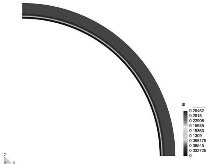
Figura 9-49. Mapa de colores del grado de saturación a 98.3 minutos.
