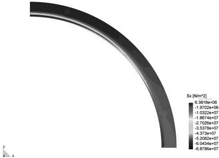
Figura 9-52. Mapa de colores de la tensión \sigma_x a 98.3 minutos.
