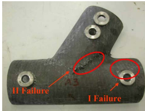
Figura 7.52 – Parte sometida a compresión. Identificación de zonas dañadas.
